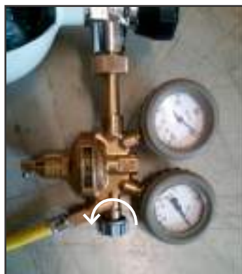
Abbildung 7.13: Lösen des Sicherheitsventils
