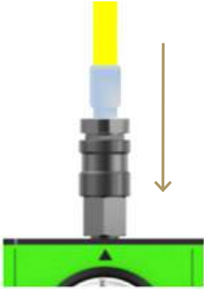
Abbildung 7.8: Die Verbindungsschläuche mit dem Steuerorgan verbinden
