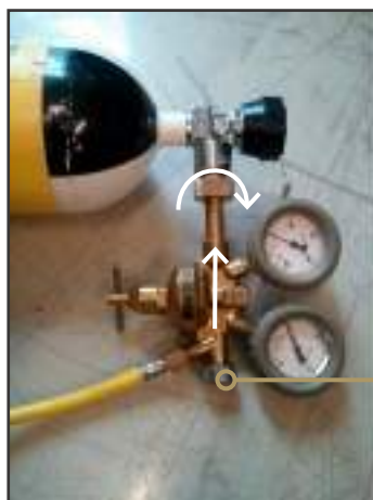
Abbildung 7.10: Den Druckminderer installieren
