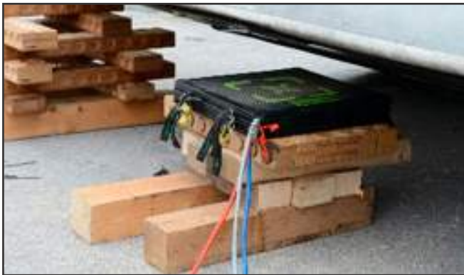
Abbildung 7.6: SAVA-Hebekissen am Ort der Nutzung positionieren
