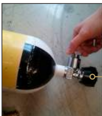
Abbildung 7.9: Den Sicherheitsstift vom Druckbehälter entfernen
